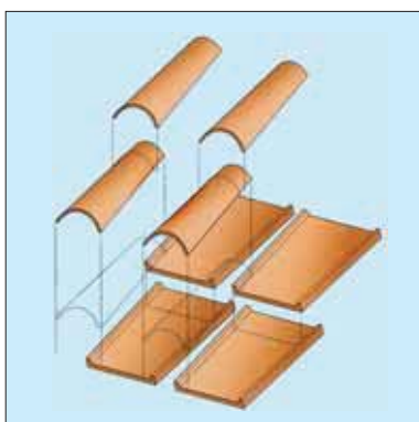
Schema di sovrapposizione dei coppi con tegole romane piane
