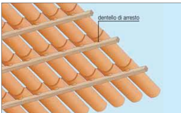
La messa in opera di coppi muniti di apposito dentello di aggancio o applicati con chiodatura può avvenire anche su una singola listellatura (alla lombarda)
