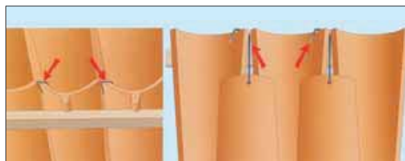
Dettaglio di intradosso ed estradosso di coppi con dente e con foro fissati tra loro con apposito gancio
